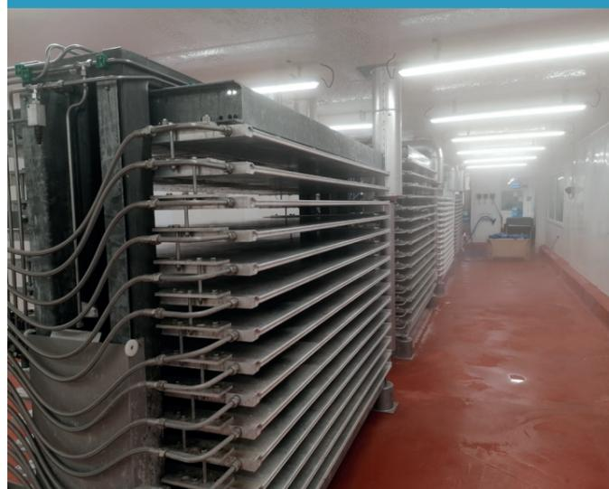
Cette augmentation de la capacité de surgélation a nécessité également l'augmentation de nos capacités à produire du froid. Pour ce faire nous avons changé notre système froid par un système au CO2, plus écologique et économique.
